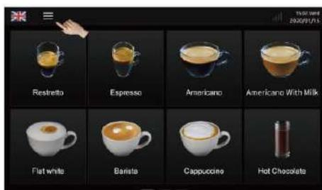
Шаг 2: Нажмите на значок промывки устройства заваривания более 3 секунд для запуска полной очистки устройства. Затем следуйте указаниям на дисплее.
