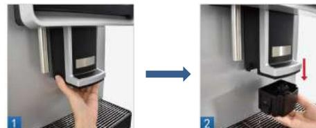
Шаг 2: Вытащите соединение и силиконовую деталь из устройства, промойте их водой. Затем установите обратно.
