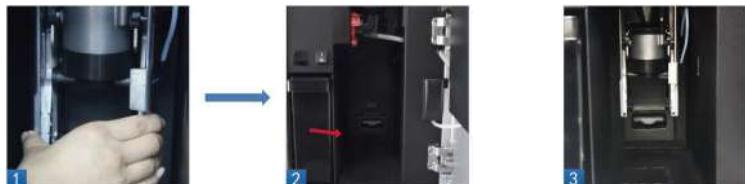
Шаг 2: Переведите фиксатор в верхнее положение, до фиксации устройства. Затем установите контейнер для отходов.
