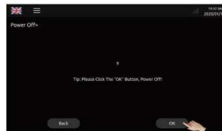
Шаг 4: После выключения, откройте дверцу и нажмите выключатель электропитания, чтобы полностью отключить питание.
