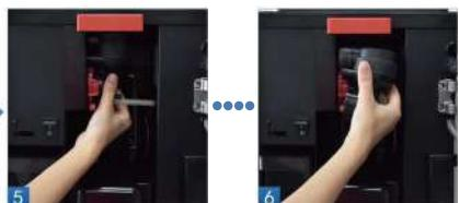
Шаг 2: Поместите промытый и высушенный миксер обратно в машину, поверните фиксатор по часовой стрелке и закройте дверцу резервуара для воды.
