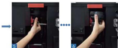
Шаг 2: Поместите промытый и высушенный миксер обратно в машину, поверните фиксатор по часовой стрелке и закройте дверцу резервуара для воды.
